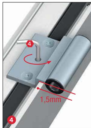
Tramite l'unità di regolazione portare la cerniera lato anta fino ad 1,5mm dal profilo.
