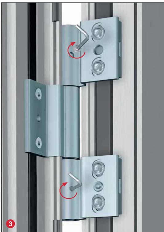
Fissare il perno nella cerniera lato telaio dal lato posteriore tramite i grani.
