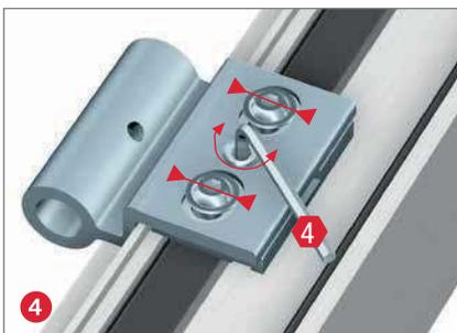
4 Regolare l'eccentrico per posizionare le viti centralmente nell'asola (corrisponde posizione zero in altezza). Serrare le due viti di fissaggio (5-9 Nm).
