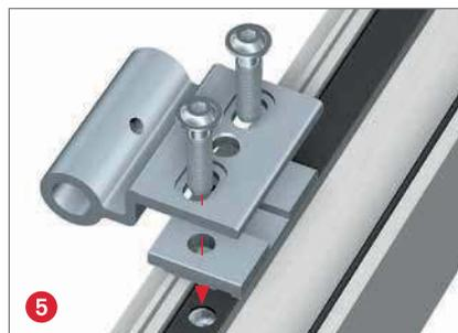
5 Appoggiare la seconda cerniera lato telaio con l'adattatore e serrare leggermente.
