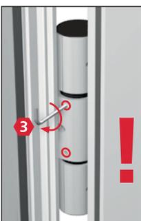
Fissare il perno di supporto in modo alternato
