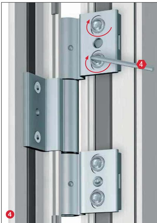
Serrare la cerniera superiore lato telaio (5-9Nm).
