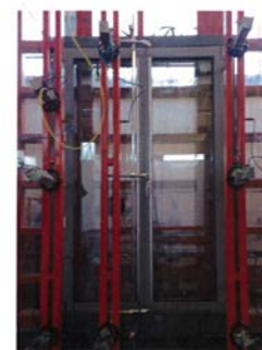
Foto 2. Campione sottoposto a prova nell'assetto sperimentale durante i test di resistenza al carico del vento (prova di deformazione)
