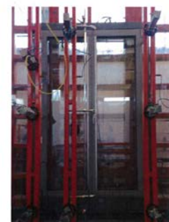
Foto 2. Campione sottoposto a prova nell'assetto sperimentale durante i test di resistenza al carico del vento (prova di deformazione)
